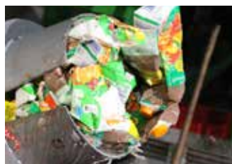
Entleeren der Gebinde bis zu 98 %
